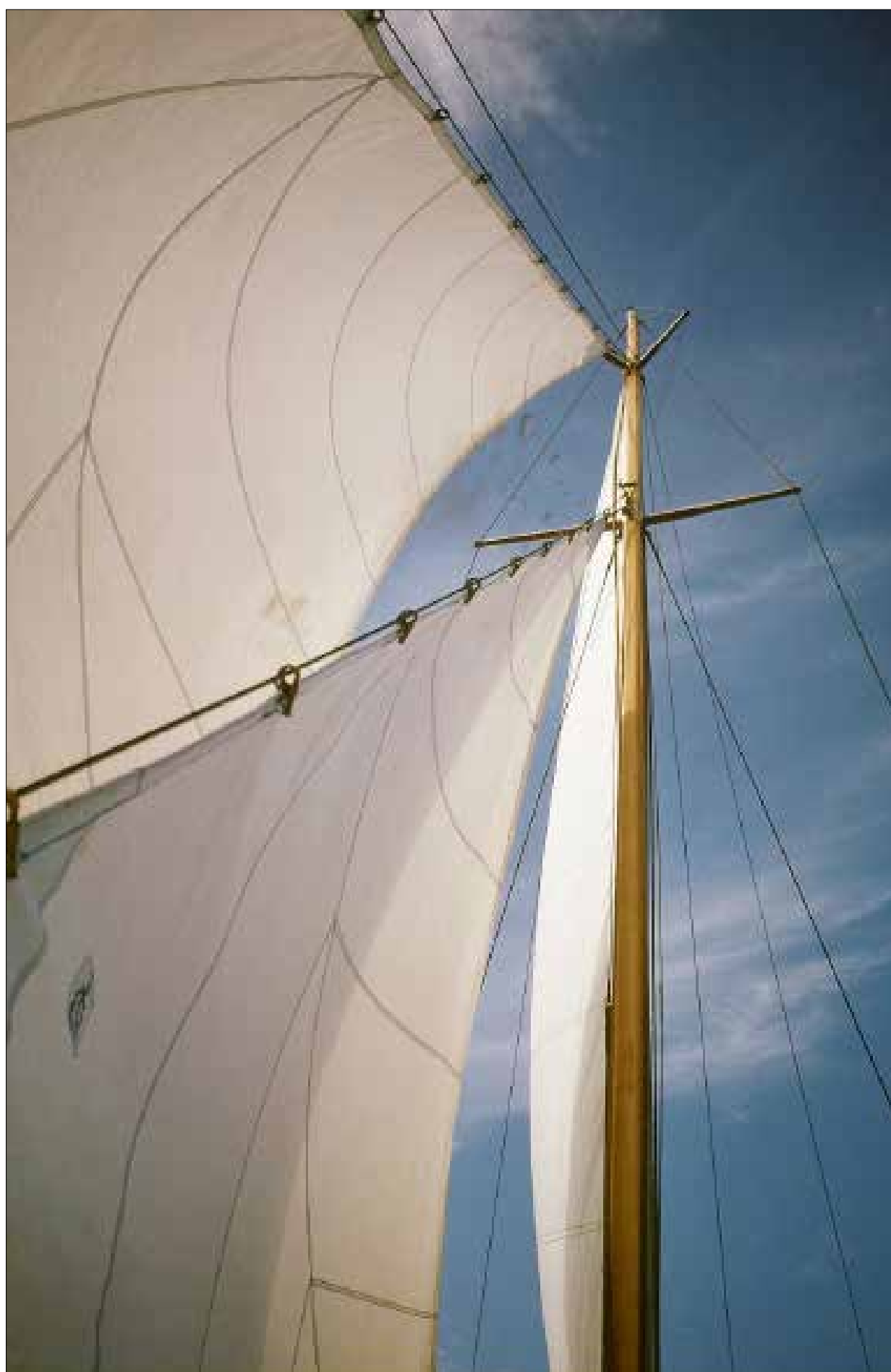
On remarquera le double étai et ses drailles de foc
